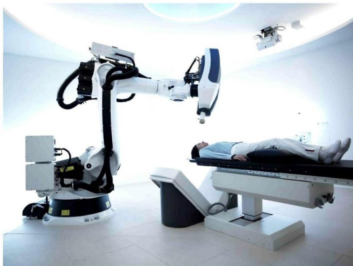
Радиохирургическая система «Кибернож», использующая рентгеновское излучение
