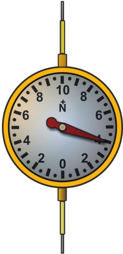
Прибор для измерения силы называется динамометром.
