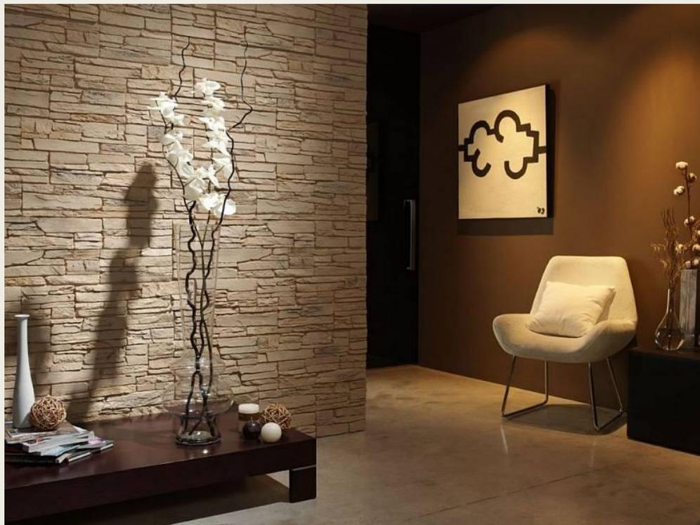
Этот вид, отличается большими размерами. Зато, позволяет быстро смонтировать панели на большой площади. Листы 122x244 см и толщиной 6 мм изготавливают из многослойных ДВП с разнообразной пропиткой или из ПВХ. Часто имитируют камень, дерево и крепятся к стене при помощи клея. Они легкие, прочные, обрешетку для их монтажа, можно не делать.
