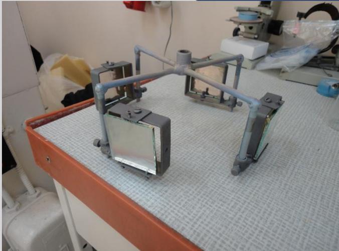
Предварительно обезжиренные образцы листового стекла помещались в вакуум-плазменную установку Unicoat 200
