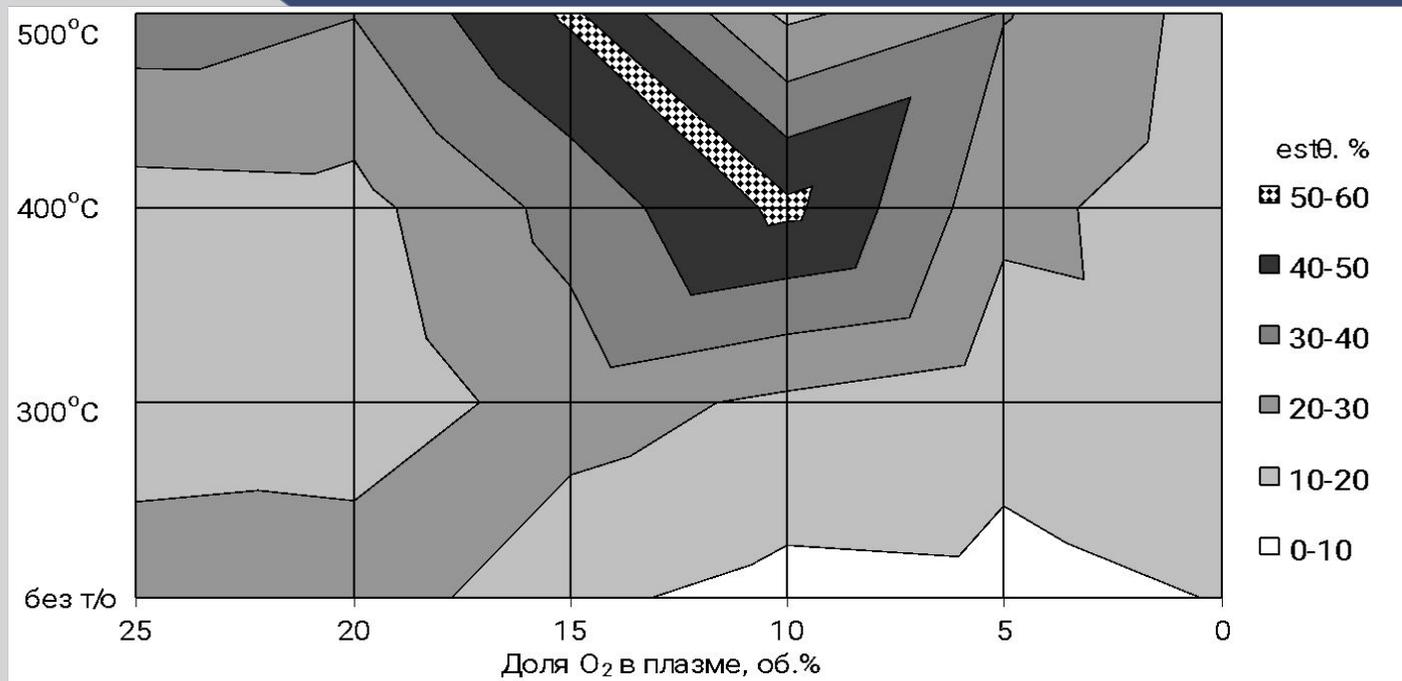
Зависимость смачиваемости от условий синтеза покрытий
