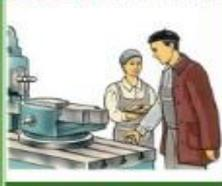
**СВЕТИЛЬНИК ДОЛЖЕН БЫТЬ НАПРАВЛЕН В РАБОЧУЮ ЗОНУ И НЕ СЛЕПИТЬ ГЛАЗА (НАПРЯЖЕНИЕ - 42 В)**
