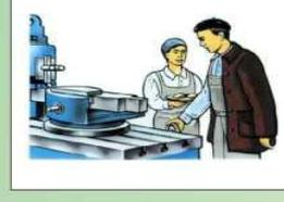
**СВЕТИЛЬНИК ДОЛЖЕН БЫТЬ НАПРАВЛЕН В РАБОЧУЮ ЗОНУ И НЕ СЛЕПИТЬ ГЛАЗА (НАПРЯЖЕНИЕ - 42 В)**
