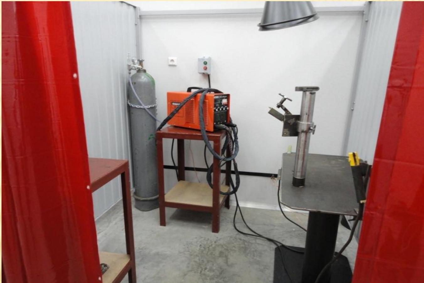
Стационарное рабочее место имеет компактные размеры (в среднем около 4 кв.м.), может располагаться на открытом пространстве цеха или быть отделено специальными шумопоглощающими перегородками.
