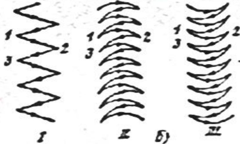
Схема движения электрода: а – перемещение электрода в трех направлениях, б – наплавка уширенных валиков, 1 – прямолинейное, 2 – криволинейное, выпуклостью в сторону сваренного участка, 3 – то же, выпуклостью в сторону несваренного участка
