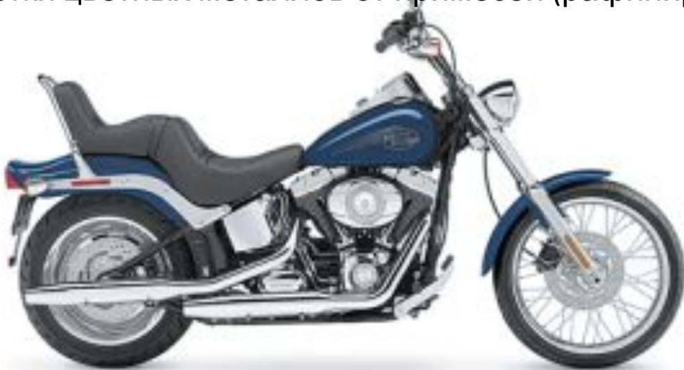
**Рис. 78.** Хромированный мотоцикл — пример техники гальваностегии
