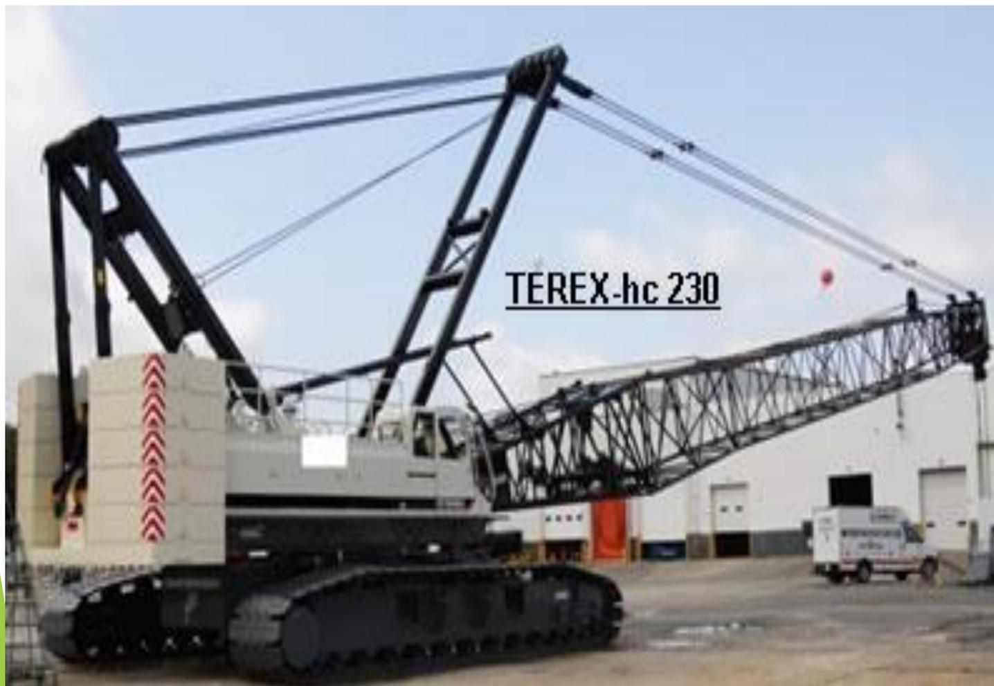
Гусенично-стреловые самоходные краны монтируются на базе специальных 2-х гусеничных шасси, обеспечивающих за счет большой опорной поверхности гусениц- высокую проходимость и устойчивость машины.
