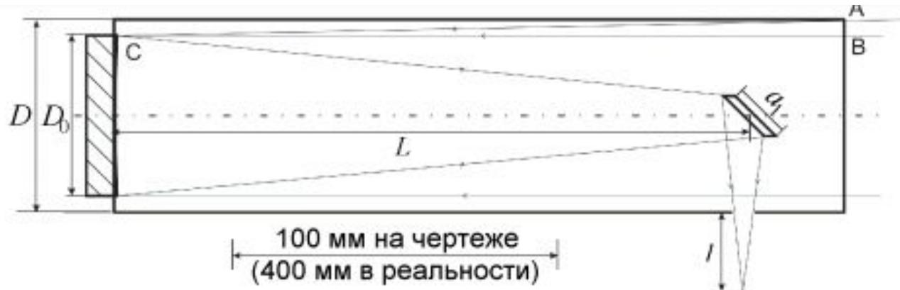
Вычислим масштаб изображения. Угловому расстоянию в  $1^\circ$  ( $1/57.3$  радиан) будет соответствовать линейный размер  $d$  в фокальной плоскости. Он зависит только от фокусного расстояния телескопа и равен
