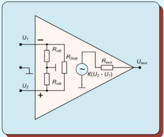
Рис.8.4. Эквивалентная схема ОУ.
