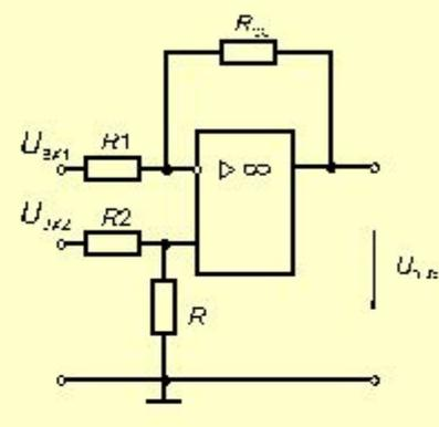
$$U_{вых} = U_{вх2} \frac{R}{R_2 + R} \left(1 + \frac{R_{вых}}{R_1}\right) - U_{вх1} \frac{R_{вых}}{R_1}$$
