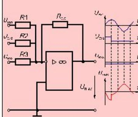
$$U_{вых} = -\left(\frac{R_{вых}}{R_1}U_{вх1} + \frac{R_{вых}}{R_2}U_{вх2} + \frac{R_{вых}}{R_3}U_{вх3}\right)$$
