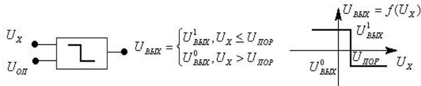
В качестве компараторов обычно используют операционные усилители. Входные ( $U_{вх+}$ ,  $U_{вх-}$ ) и выходное ( $U_{вых}$ ) напряжения ОУ связаны соотношением:  $U_{вых} = K_{оу} (U_{вх+} - U_{вх-})$ , (1) где  $K_{оу}$  - коэффициент усиления операционного усилителя.
