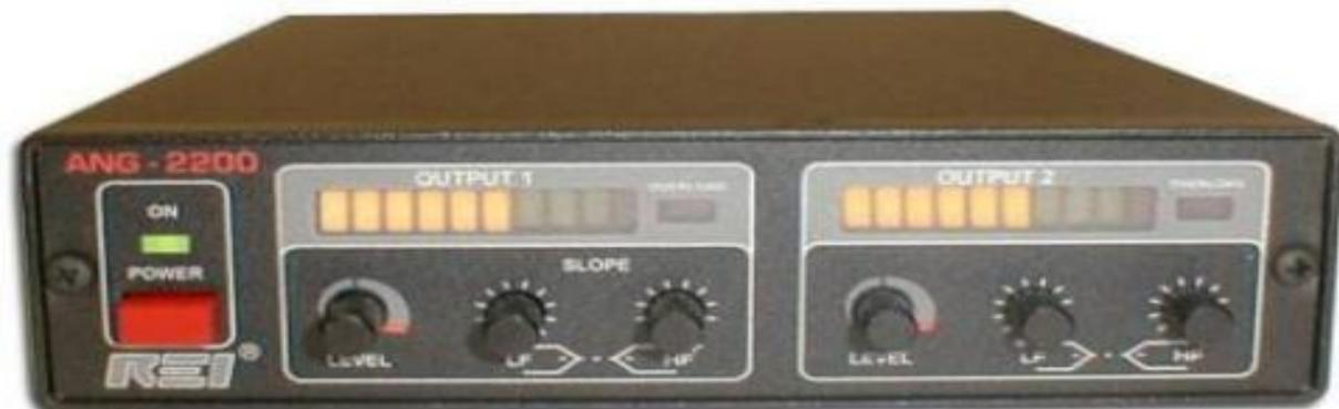
ANG-2200 предназначен для создания вибро-акустических помех с целью защиты от проводных и радио- микрофонов, вмонтированных в стену, а также лазерных и микроволновых систем, использующих отражение от окон
