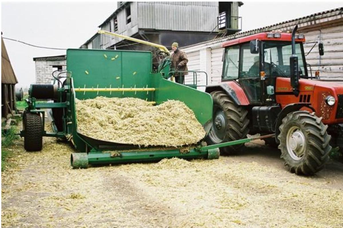
Упаковщик силосно-сенажной массы УСМ-1 предназначен для упаковки измельчённых травяных кормов (сенажа, силоса) в полимерный рукав. Упаковщик агрегируется с трактором МТЗ-1221. Себестоимость закладки кормов на хранение в полимерный рукав в 2,3 раза меньше по сравнению с закладкой в бетонное наземное хранилище. При сохранении высокого качества кормов потери при хранении снижаются на 10-20%.
