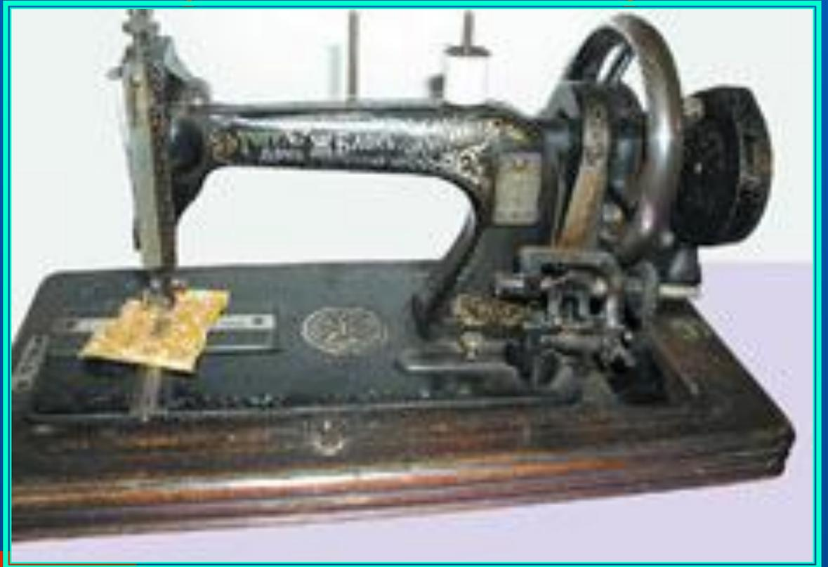
*Фабрично-ремесленная швейная машина „Гоу“ челночного стежка для стачивания тяжелых тканей. Изготовлена на фирме „Гоу-машина-компани“ (США, Нью-Йорк, 1865-1875), принадлежащей семье изобретателя швейной машины челночного типа Элиаса Гоу. Применялась в основном для шитья парусов для флота.*
