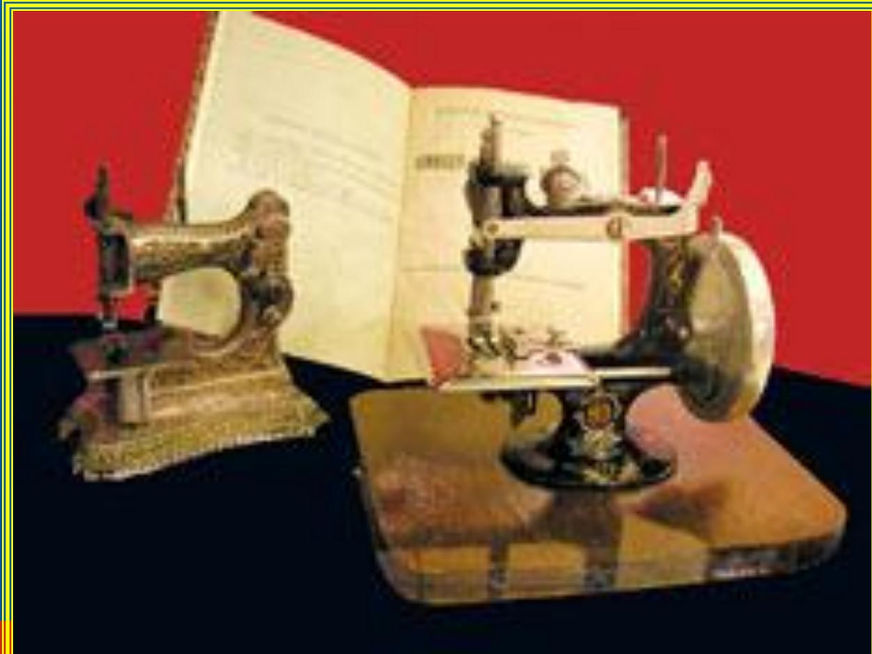
*Швейная машина челночного стежка для стачивания тканей (подольский завод компании „Зингер“, 1905-1920). Её корпус имеет так называемую бутылочную форму, которая была запатентована фирмой „Зингер“ в конце XIX века.*
