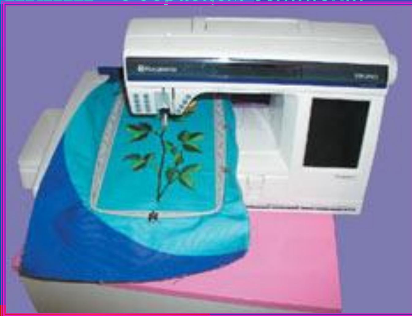
Швейная машина с электронным управлением. Перемещением иглы относительно ткани управляет микропроцессор.
