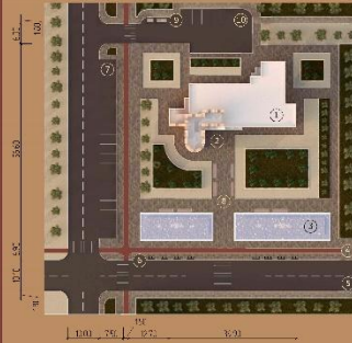
Схема планировочной организации земельного участка, М 1:500
