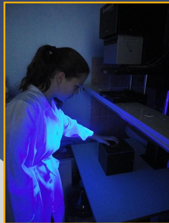
Стаканы, герметично закрытые прозрачной полиэтиленовой плёнкой, облучались УФ- светом с помощью ультрафиолетовой лампы с электрической мощностью 18 Вт, располагаемой на расстоянии 75 мм от поверхности образца.
