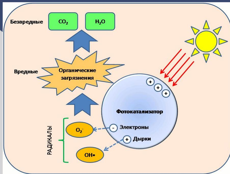
Процесс окисления или восстановления органических соединений, который происходит при участии фотокатализатора под действием света
