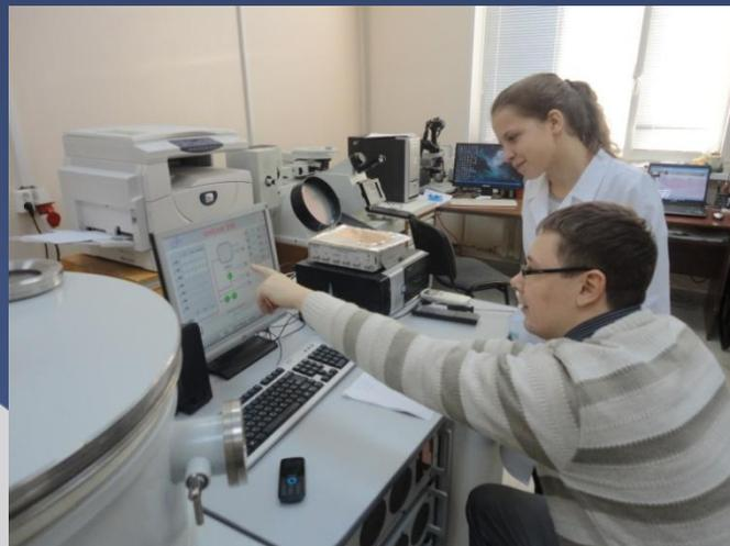
Эксперимент проводился по режиму: напряжение 420–520 В; сила тока 3,3 А; общее давление – 0,22 Па; время напыления – 30 мин. Часть образцов термообрабатывалась на воздухе. Варьировалась доля кислорода в плазме от 0 до 25 % с шагом 5 %;
