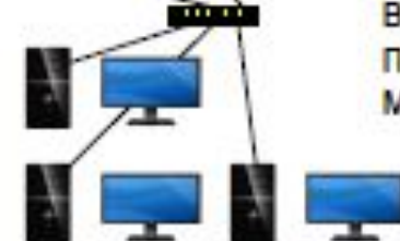
Управляющие ПК и RTDS подключаются через локальную сеть Ethernet
