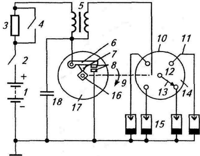
В момент размыкания контактов 8 ток в первичной обмотке катушки зажигания 5 и созданное им магнитное поле исчезают. Во вторичной обмотке катушки зажигания индуктируется ЭДС, тем большая, чем выше скорость исчезновения магнитного поля. В это время токопроводящая пластина ротора 13 распределителя 14 проходит около бокового электрода 12 крышки распределителя, соединенного высоковольтным проводом со свечой зажигания 15 того цилиндра, в котором заканчивается процесс сжатия топливовоздушной смеси.
