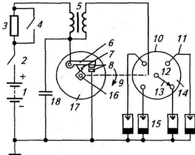
При вращении вала прерывателя-распределителя 9, кулачком 16 попеременно замыкаются и размыкаются контакты 8 прерывателя 17.
