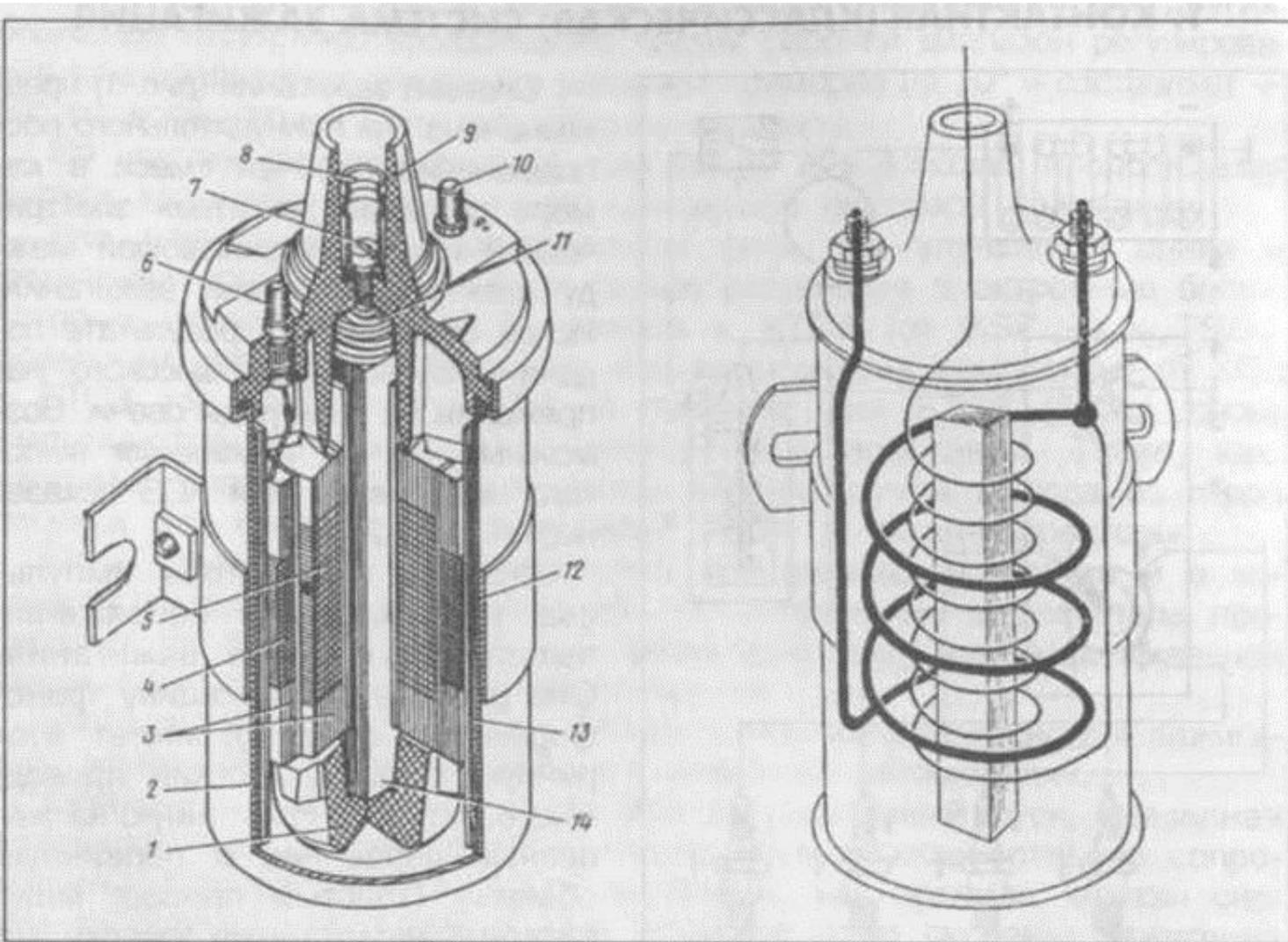
Устройство катушки зажигания:
