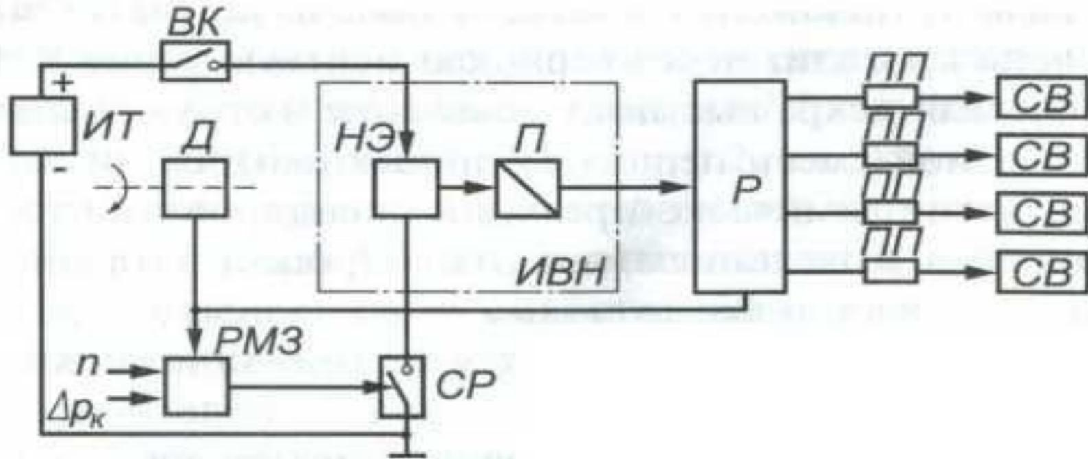
ИТ-источник тока, функцию которого выполняет аккумуляторная батарея или генератор;
