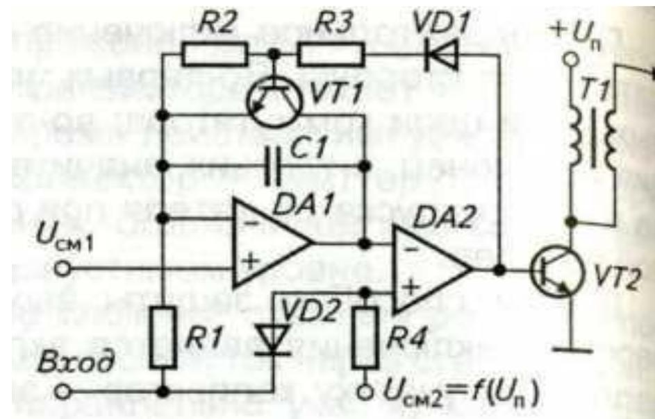
Типовая схема программного регулятора времени накопления
