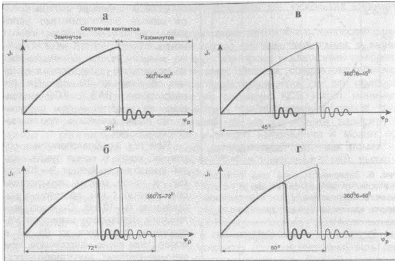
Зависимость тока разрыва  $I_{1p}$  (J,) от угла поворота вала распределителя ( $\varphi_p$ ) для 4 (а), 5 (б), 8 (в) и 6-цилиндровых (г) двигателей
