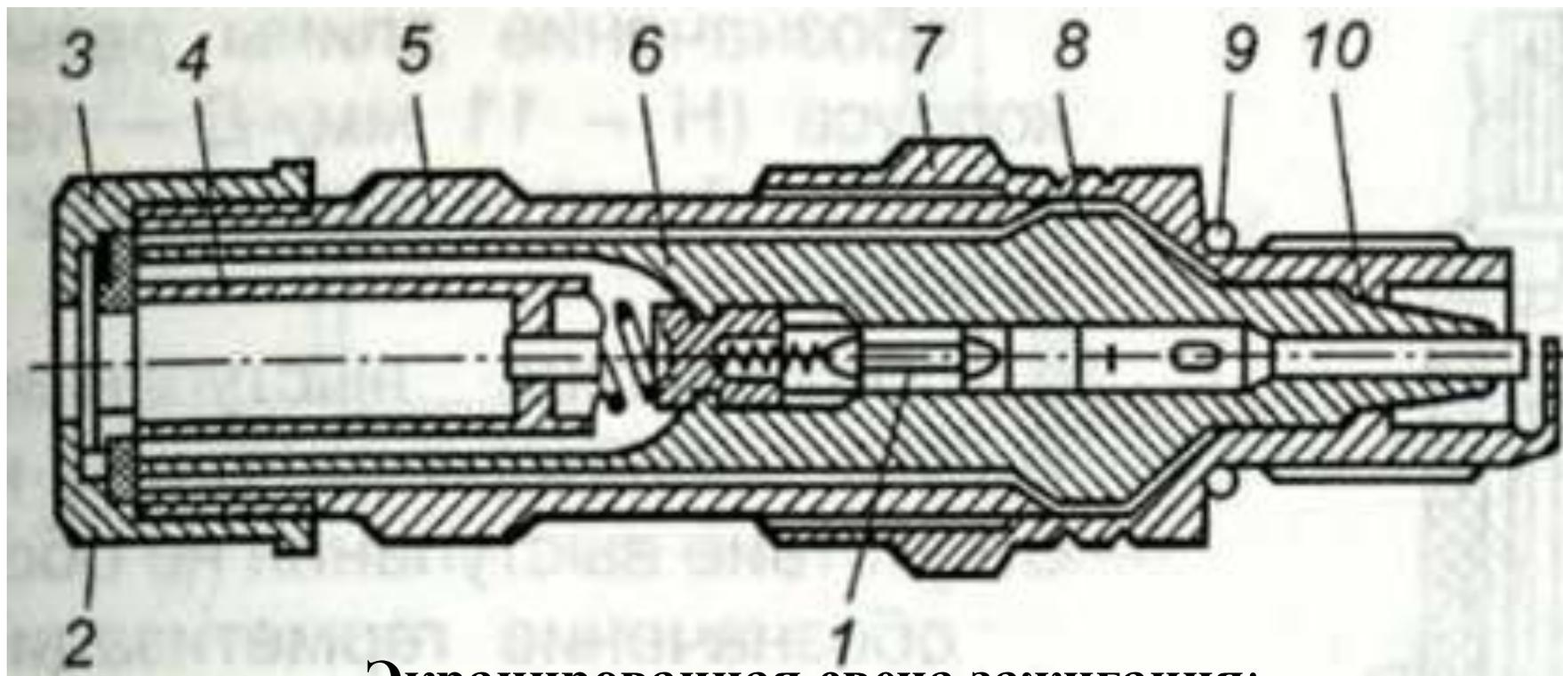
**Экранированная свеча зажигания:**
