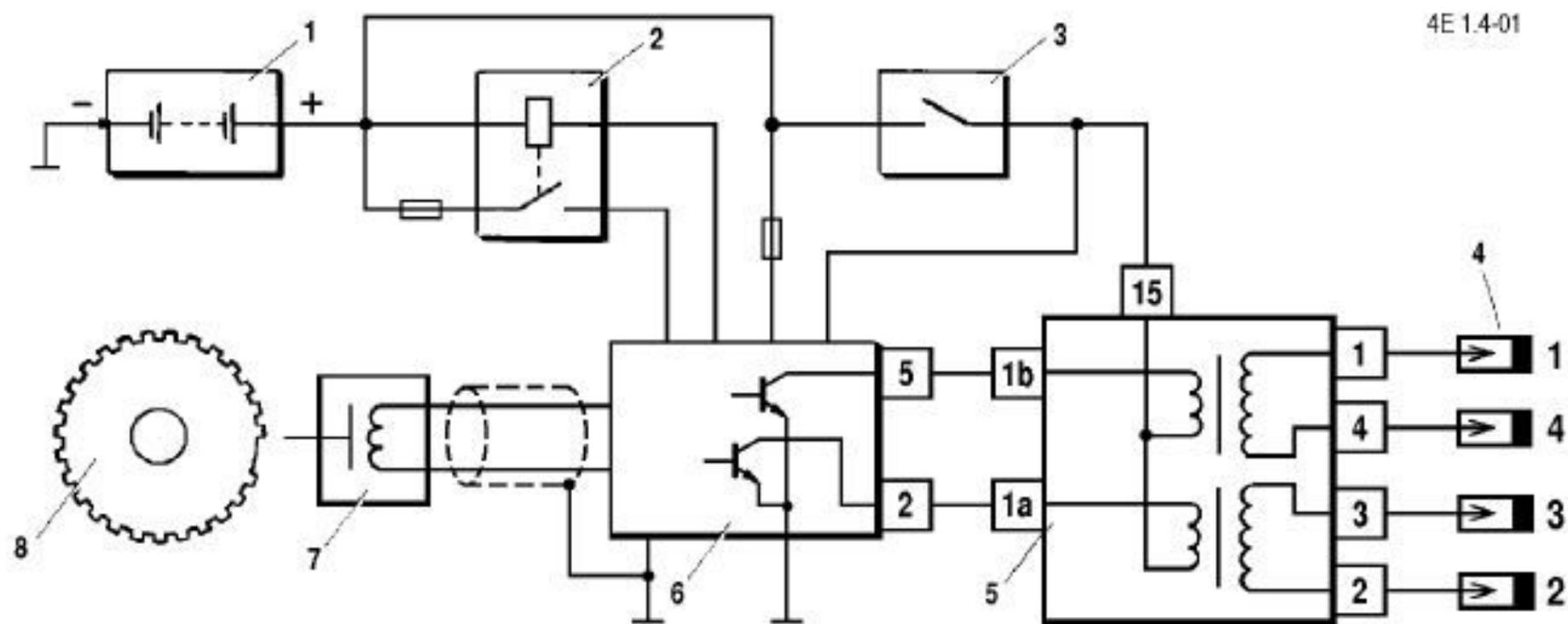
**Рис. 1.4-01. Система зажигания:** 1 - аккумуляторная батарея; 2 - реле главное; 3 -- выключатель зажигания; 4 - свечи зажигания; 5 - катушка зажигания; 6 - контроллер; 7 - датчик положения коленчатого вала; 8 - задающий диск
