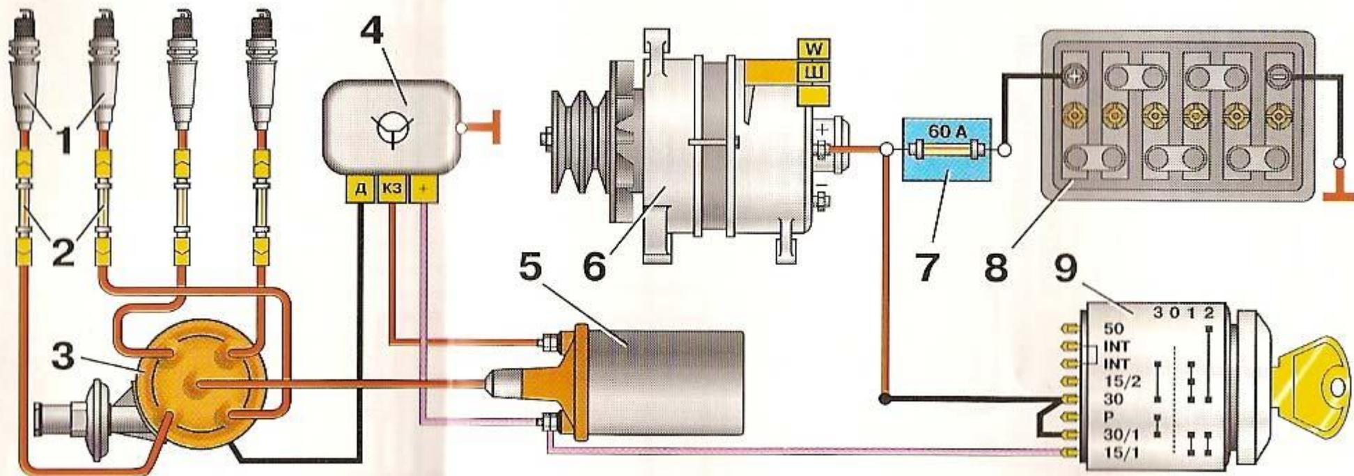
1 – свеча зажигания; 2 – помехоподавительное сопротивление; 3 – датчик-распределитель; 4 – коммутатор; 5 – катушка зажигания; 6 – генератор; 7 – блок предохранителей в моторном отсеке; 8 – аккумуляторная батарея; 9 – выключатель зажигания
