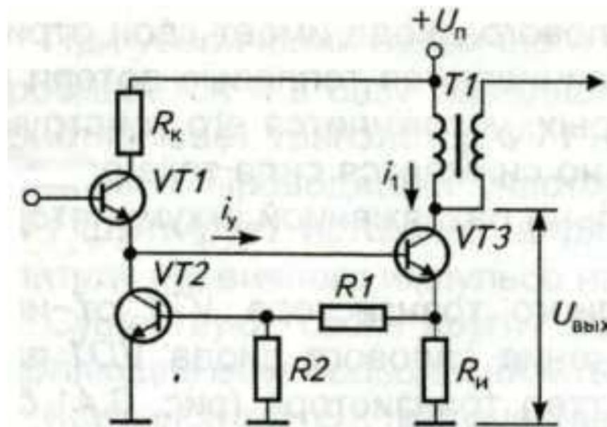
Выходной каскад коммутатора с ограничителем амплитуды импульса первичного тока
