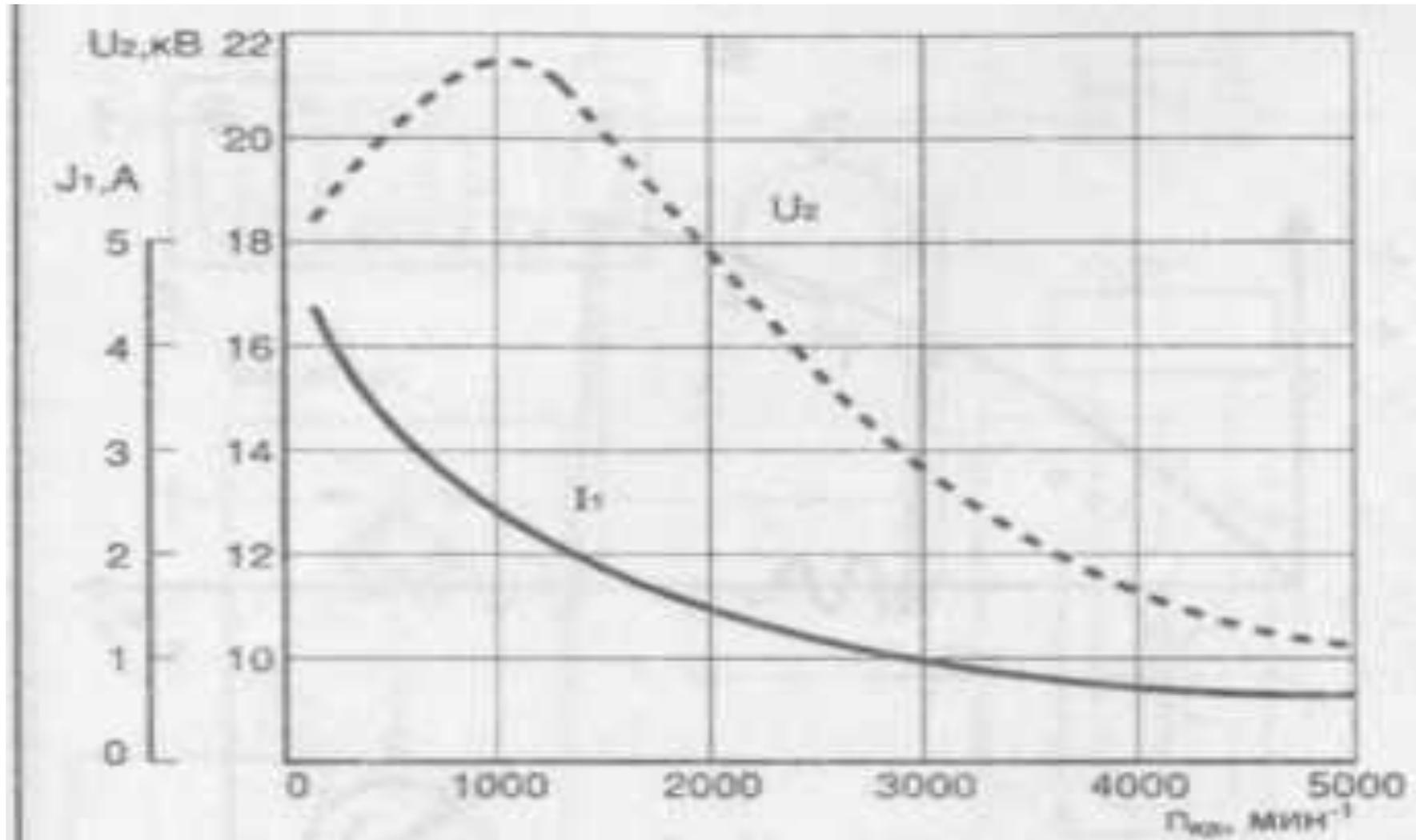
Зависимость тока разрыва  $I_{1p}$  (А), максимального значения напряжения вторичной обмотки катушки зажигания  $U_{2m}$  от частоты вращения коленчатого вала двигателя
