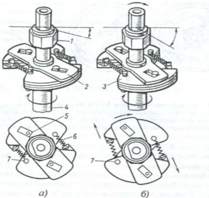
На приводном валу 4 регулятора закреплена пластина с осями 7, вокруг которых могут поворачиваться грузики 3, связанные между собой пружинами. Привод кулачка 1 прерывательного механизма от вала 4 осуществляется через грузики со штифтами 5, которые входят в прорези поводковой пластины 2, жестко прикрепленной к втулке кулачка.
