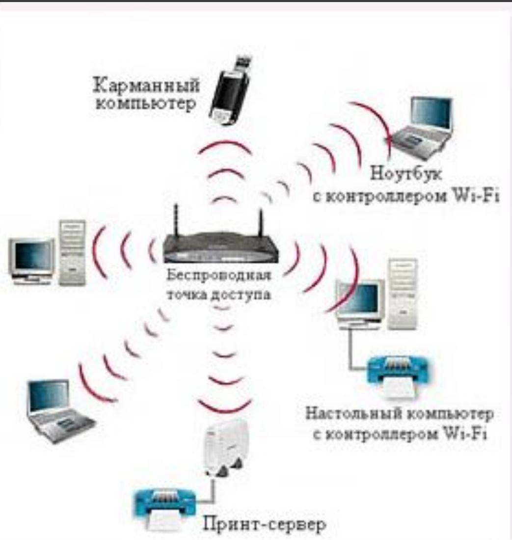
Технология беспроводной связи. Дальность действия—10-5000 м. Скорость передачи данных до 1 Гбит/сек.
