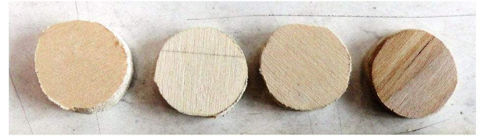
6. Просверлить отверстия в колёсах сверлом диаметра 15 мм.
