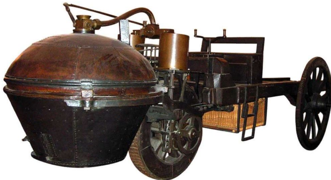
«Телега Кюньо» (1769) — первый паровой автомобиль.
