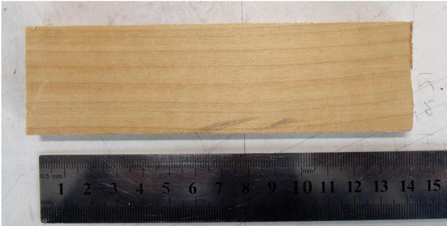
1. Отпилить основу машины размером 140 x 40 x 6 мм
