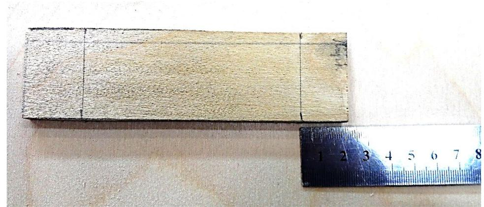
4. Сверлом 3 мм просверлить отверстия
