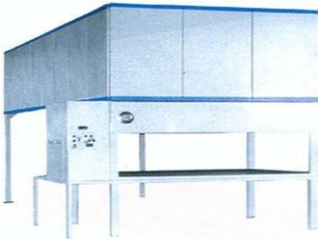
Затем расстаявшиеся тестовые заготовки на листах переставляют на люльки печи Ш2-ХПА-16 , в которой производится выпечка булок в течение 15 – 17 минут при температуре 210 – 230 0С в увлажнённой пекарной камере.
