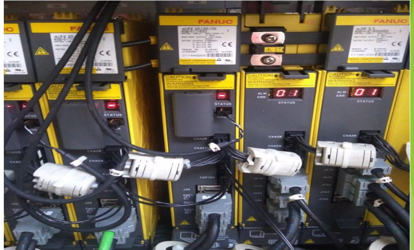
Внешний вид системы драйверов двигателей (сервоусилителей FANUC) двухшпиндельного токарного станка. На фотографии слева направо: драйверы осей Z, X и Y и два драйвера управления шпинделями станка
