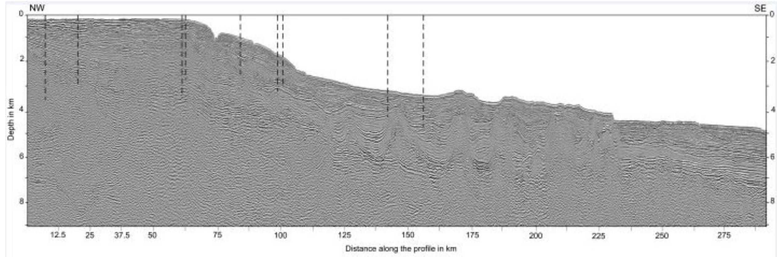
Сейсмический профиль (линия профиля на слайде 2). Пунктирными линиями обозначено расположение имеющих скважин.
