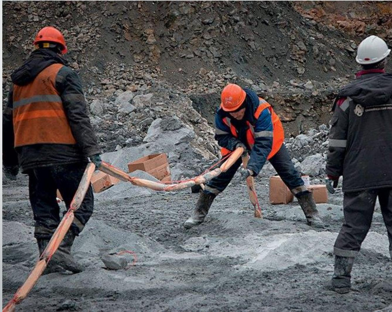
Взрывник получает взрывчатое вещество на складе, в специальной сумке привозит его на место залежей ископаемых (его определяют ученые-геологи), закладывает в установленные места детонаторы (именно от их маленького взрыва начинается цепная реакция), рассчитывает мощность ударной волны и расстояние, на которое разлетятся обломки горной породы.
