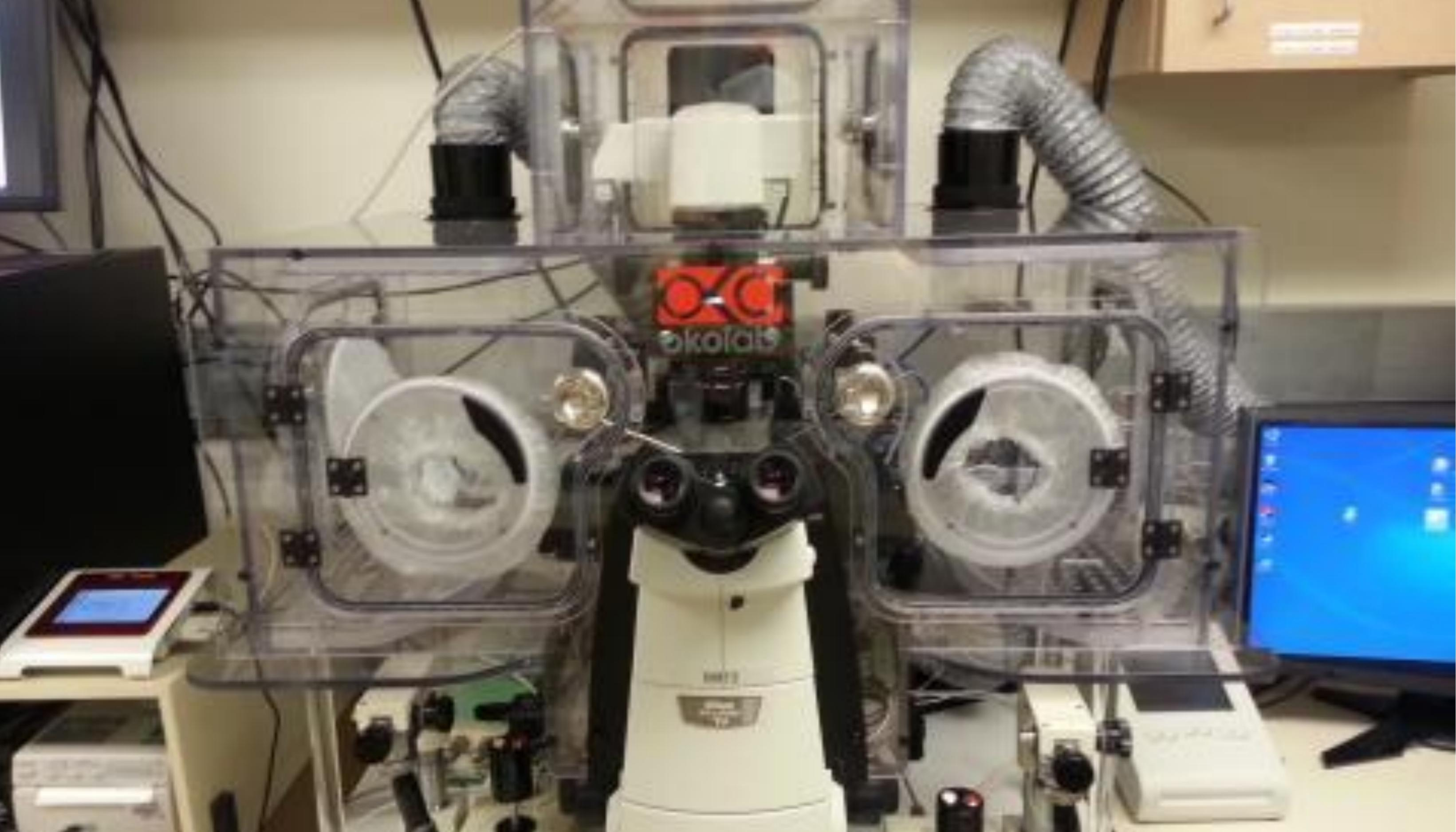
Бокс Okolab для ИКСИ (интрацитоплазматическая инъекция сперматозоида, оплодотворение в пробирке с микроинъекцией сперматозоидов) поддерживает стабильность микроклимата вокруг рабочей станции для ИКСИ, т.е постоянную температуру и концентрацию CO<sub>2</sub>.
