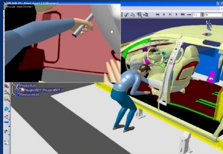
1. Проверка достигаемости и удобства доступа приборке
