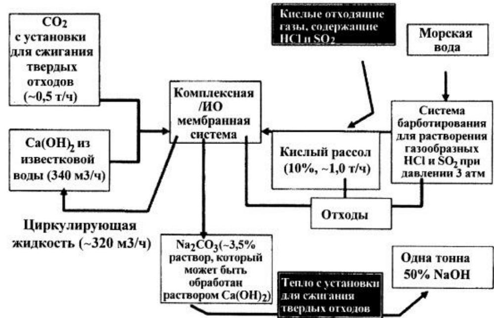
Схема технологической установки для получения гидроксида натрия с использованием твердых отходов, морской воды, подкисленной отходящими газами (или отработанной соленой воды) и негашеной извести. (Аналогичная схема используется для получения Na<sub>2</sub>CO<sub>3</sub>)
