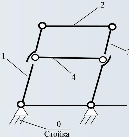
Например, в шарнирном параллелограмме (см. рис. слева) введение пассивного звена 4 и кинематических пар 1-4 и 3-4 исключает неопределенность движения ведомого звена 3 из положения, когда все звенья вытягиваются в одну линию.
