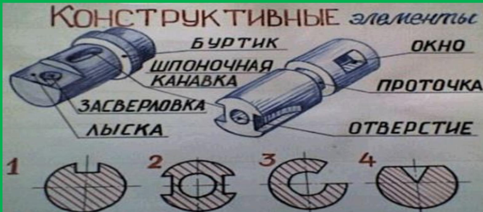
**Канавка** – углубление на поверхности меньшего диаметра между соседними ступенями валов: предназначена для плотного прилегания насаживаемой детали к заплечнику (буртику), выхода шлифовального круга, при обработке поверхности меньшего диаметра, выхода резьбонарезного инструмента.
