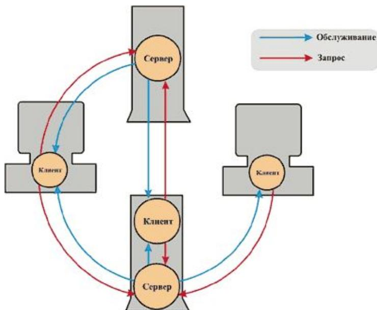
Следует различать компьютер-сервер и программу-сервер. Например, на одном и том же компьютере могут быть установлены как клиентские, так и серверные программы, то есть компьютер в различных процессах может одновременно выступать и клиентом, и сервером.
