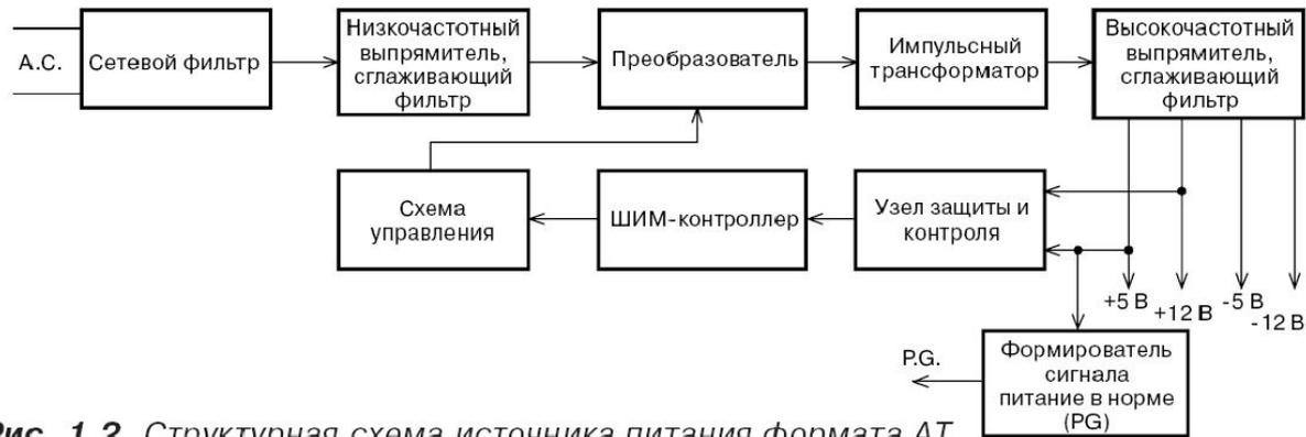
Рис. 1.2. Структурная схема источника питания формата AT
