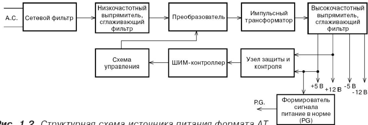
Рис. 1.2. Структурная схема источника питания формата AT
