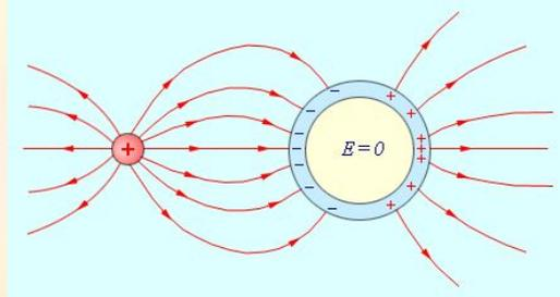
Линии напряженности перпендикулярны поверхности проводника.
