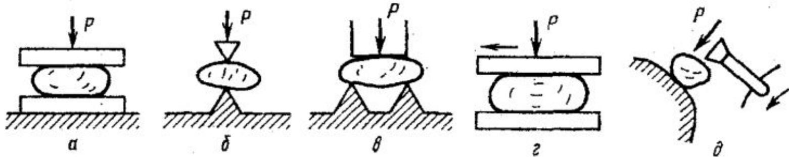
Рис. 2.6. Схемы основных способов механического дробления:
