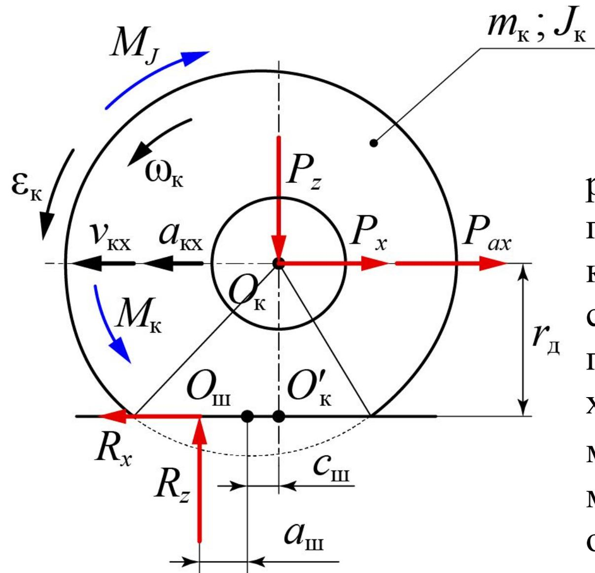
Колесо, кроме рассмотренных геометрических, кинематических и силовых параметров характеризуется массой  $m_K$  и моментом инерции относительно оси вращения  $J_K$ .
