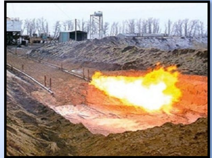
Рис.10 промышленное сжигание остаточного газа
