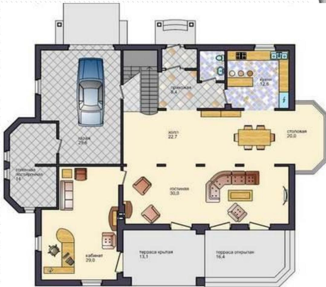
**ПЛАН ЭТАЖА ЗДАНИЯ** – называется горизонтальный разрез здания несколько выше уровня подоконника, содержащий изображения помещений, дверей, окон, толщину стен и других конструктивных элементов.
