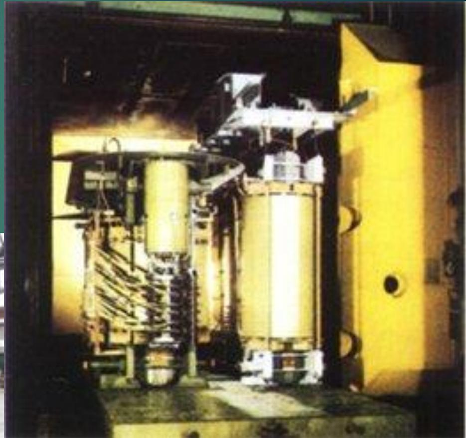
После сушки обмотку сжимают с помощью гидропресса, пока ее размер по оси не достигнет требуемого и ликвидируют дефекты обмотки, появившиеся в процессе намотки, сушки или прессовки.
