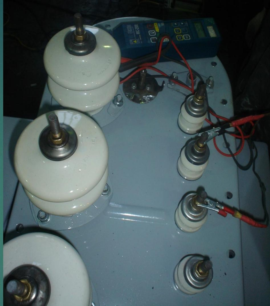
Подсоединение концов мегомметра при проверке сопротивления изоляции обмоток
