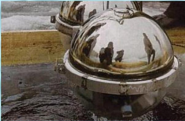
NT-200: Элементы конструкции установки из высокочувствительных фотоприемников, которые помещены в стеклянные шары выдерживающие давление до 150 атмосфер на глубине 1 100-1 200 метров.
