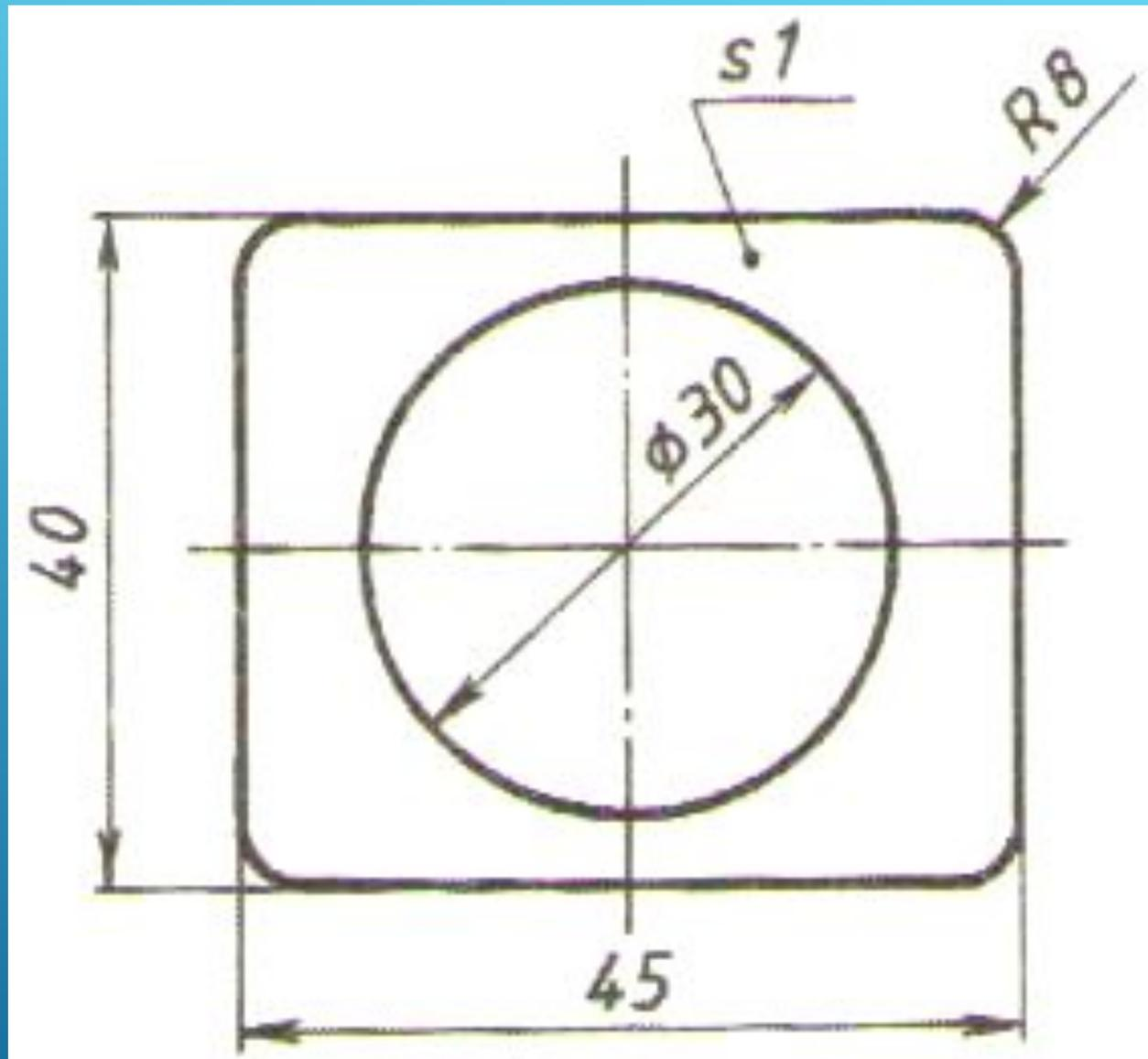
Нанесение размера толщины детали
