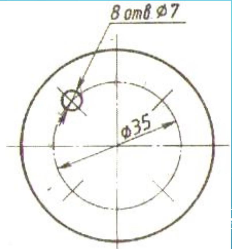
Нанесение размеров одинаковых отверстий, равномерно расположенных по окружности
