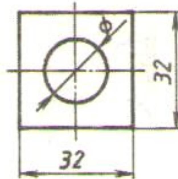
Нанесение размеров квадратных по форме элементов
