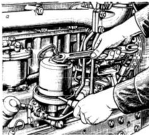
Рис. 44 а. Снятие стакана ротора вакуумного дегазатора.
