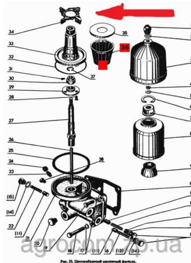
Для этого нужно сначала отвернуть гайку крепления колпака фильтра и снять его. Затем между крышкой ротора и чашкой корпуса фильтра вставить отвертку, застопорить ротор и, вращая вручную специальную гайку стакана ротора, осторожно снять стакан с ротора. Удалить деревянным скребком слой отложений с внутренней стенки стакана ротора и при необходимости очистить тангенциальные каналы в верхней части корпуса ротора.
