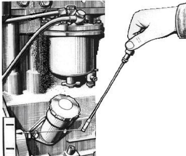
Дизель следует заправлять моторным маслом определенного сорта в строгом соответствии с заводской инструкцией по эксплуатации.
