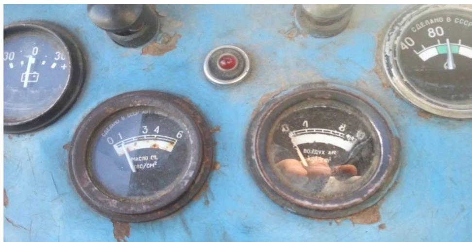
Понижение или повышение давления указывает на неисправность смазочной системы. Резкое снижение давления может произойти при утечке масла из маслопроводов, неправильной работе указателя давления (манометра), сливного или предохранительного клапана и выходе из строя масляного насоса.
