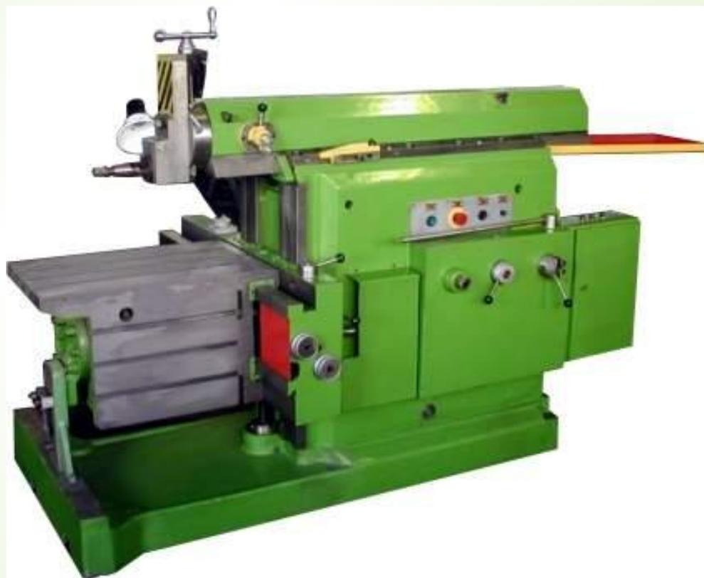
**7А36:** 7 — строгольно-протяжная группа, 3 — поперечно-строгольный, 6 — максимальная длина обрабатываемой детали 600 мм, А указывает на модернизацию станка базовой модели 736.
