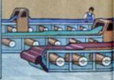
Рассекание настила на части с помощью электрораскройных машин
