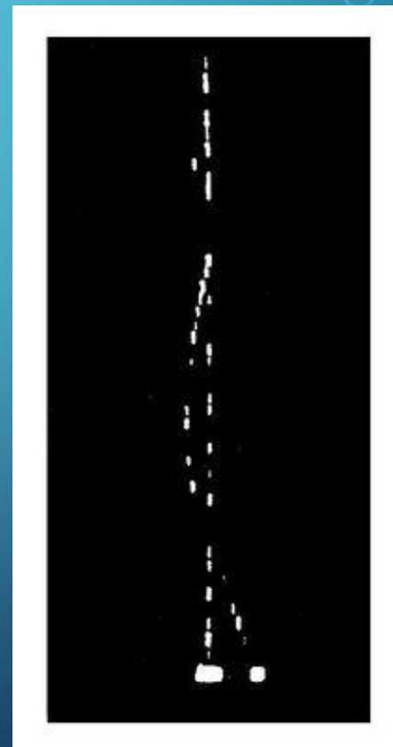
Трек частицы в узкозасорной искровой камере
