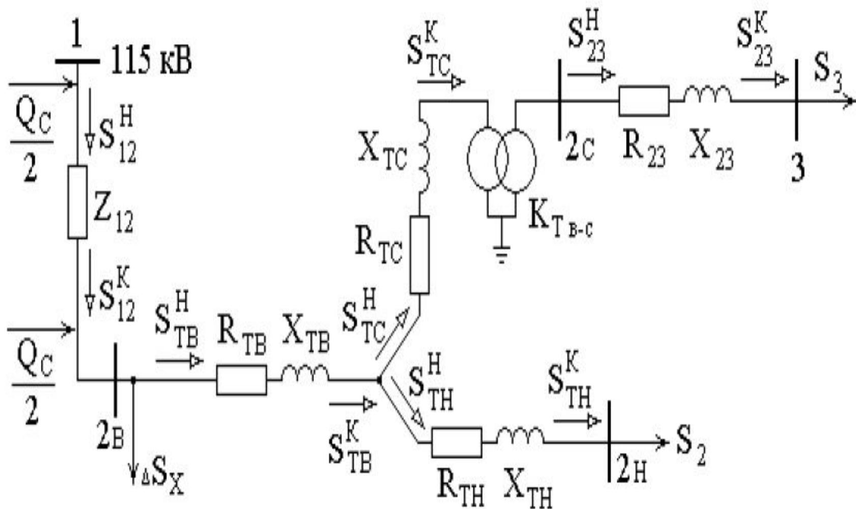
Параметры схемы замещения трехобмоточного трансформатора берем из [2,табл.6.46]:
