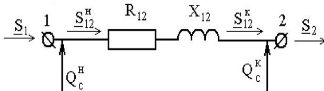
Поскольку задана точная величина напряжения в конце линии, уточняем зарядную мощность в конце линии:
