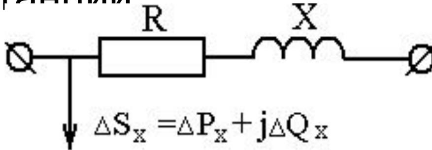
Определяем параметры одного трансформатора
