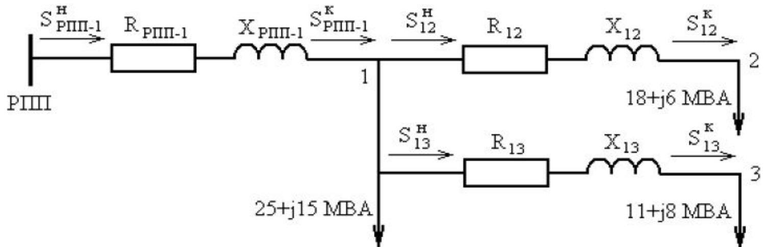
Выполняем первый этап расчета режима - определяем потокораспределение с учетом потерь в линиях. Мощность в конце и в начале участка 1-3:
