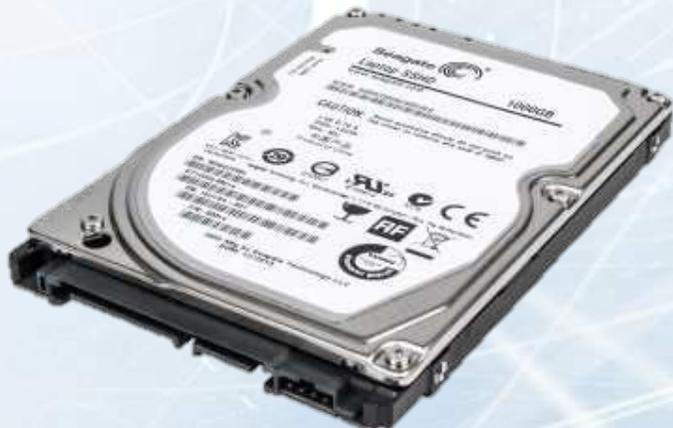
Основным устройством долговременного хранения информации является **винчестер** (жесткий диск). Винчестер находится внутри системного блока, но относится к внешним устройствам памяти. Существуют винчестеры, которые могут подключаться к системному блоку.
