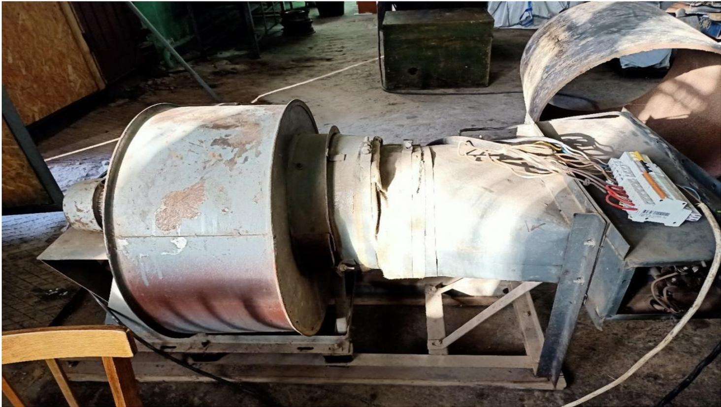
Рис. 3 – Нагрузочный элемент (калорифер).
