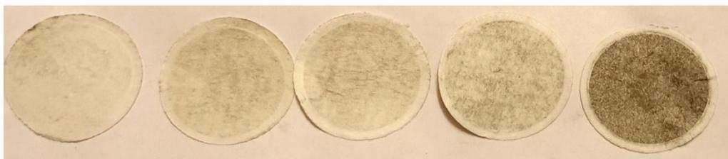
Рис 5 - фильтровочные диски, газодизельный цикл
