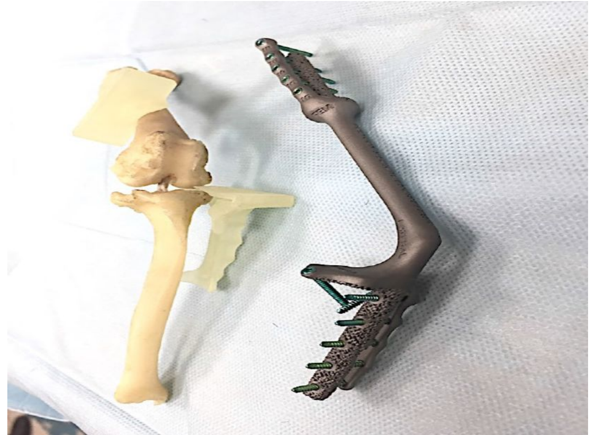
Внешний вид изготовленного эндопротеза (SLM печать) и ПХН. Пористая часть в области контакта с костью.
