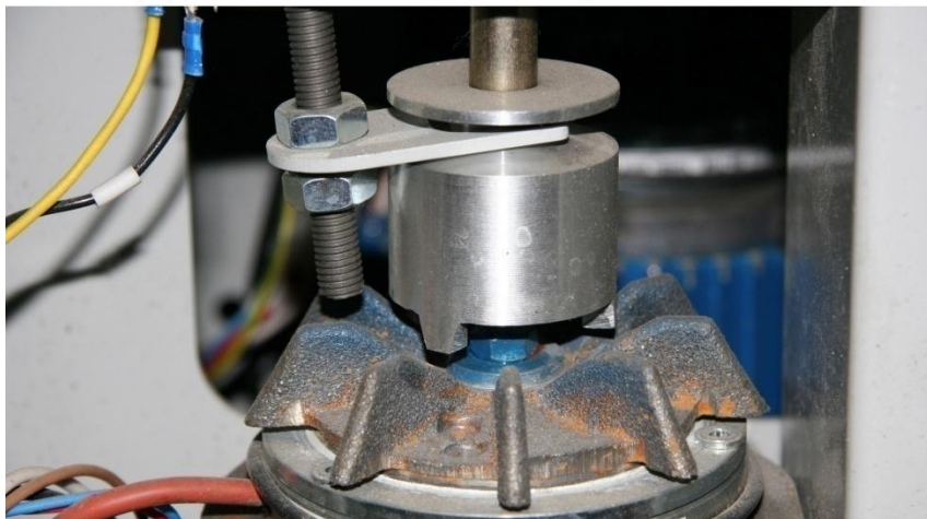
Муфта механизма включения привода при ручном опускании платформы
