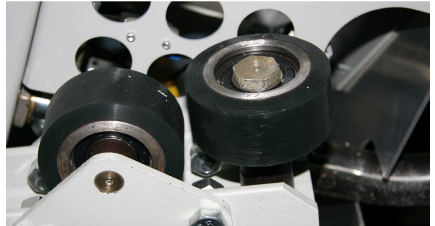
Ролики направляющих для перемещения платформы
