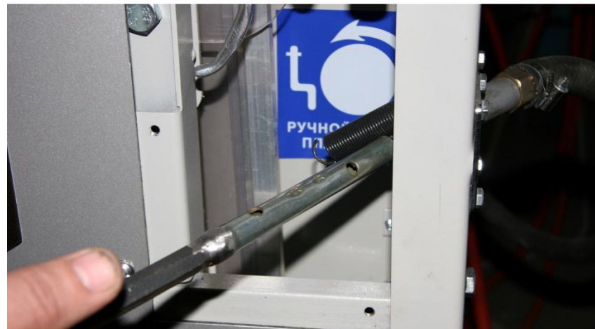
Установка специального ключа для ручного опускания платформы
