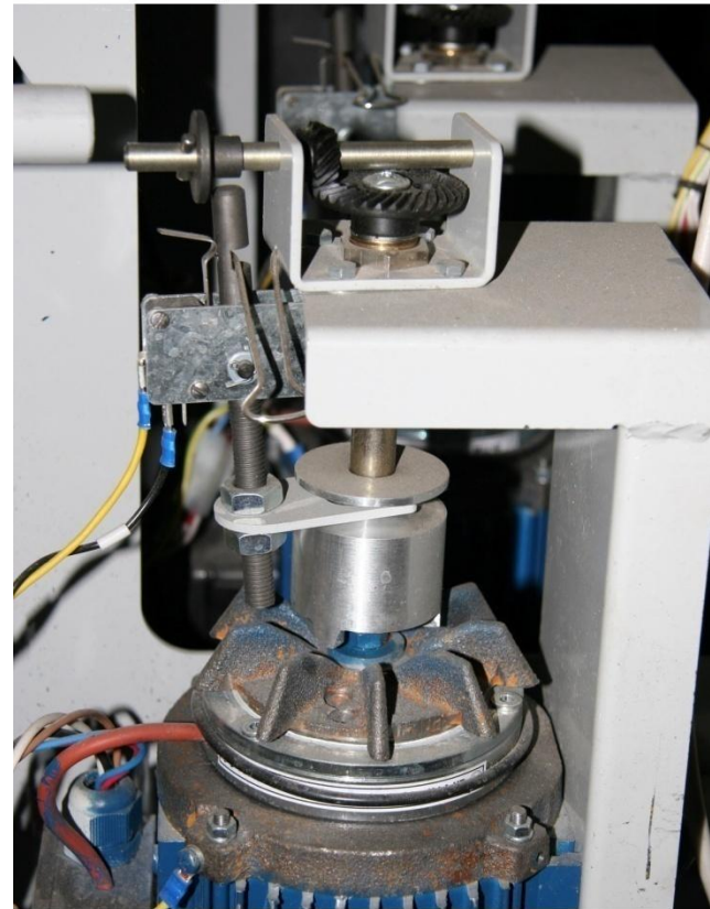
Механизм включения привода при ручном перемещении платформы
