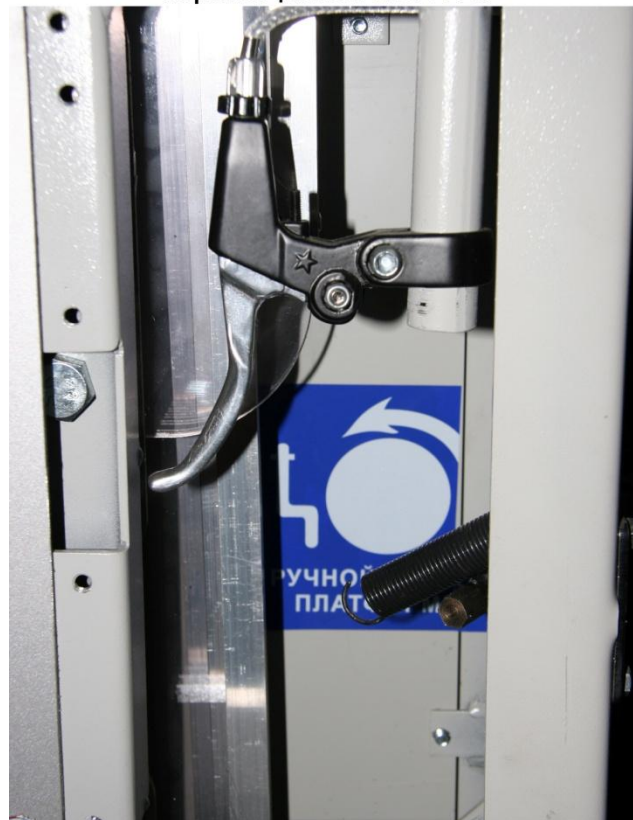
Фиксатор рычага выключения блокировки привода при ручном опускании платформы
