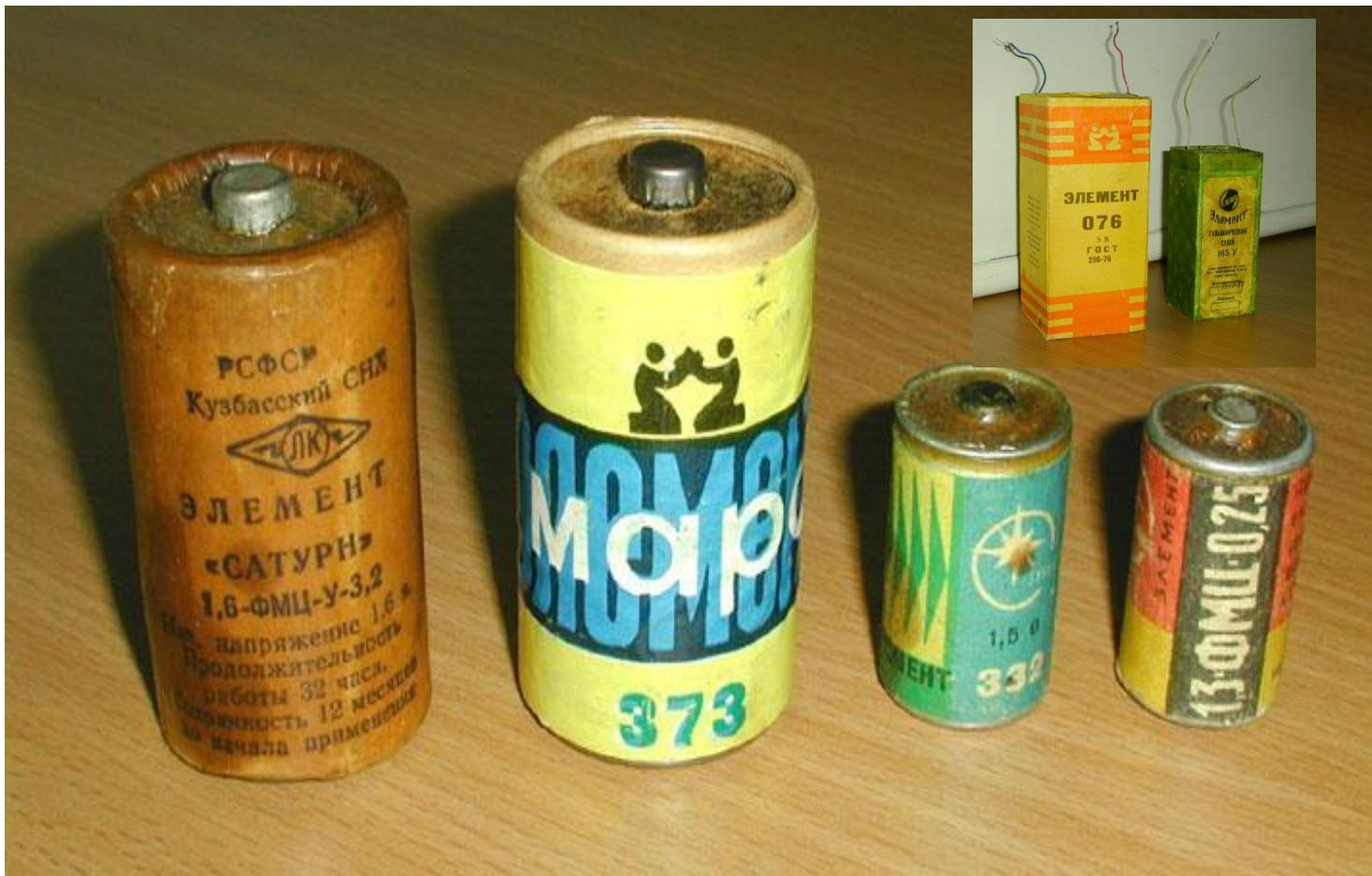
**Батарея (элемент питания)** - общедное название источника электричества для автономного питания портативного устройства. Может представлять собой одиночный гальванический элемент, аккумулятор или их соединение в батарею для увеличения напряжения.
