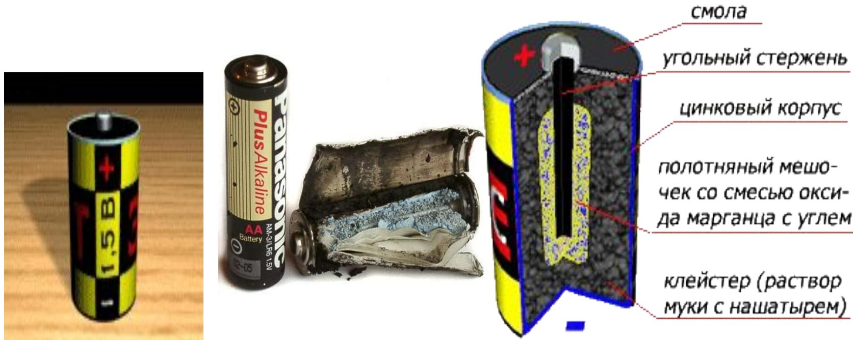
**Гальванический элемент**- химический источник тока, в котором электрическая энергия вырабатывается в результате прямого преобразования химической энергии окислительно-восстановительной реакцией.
