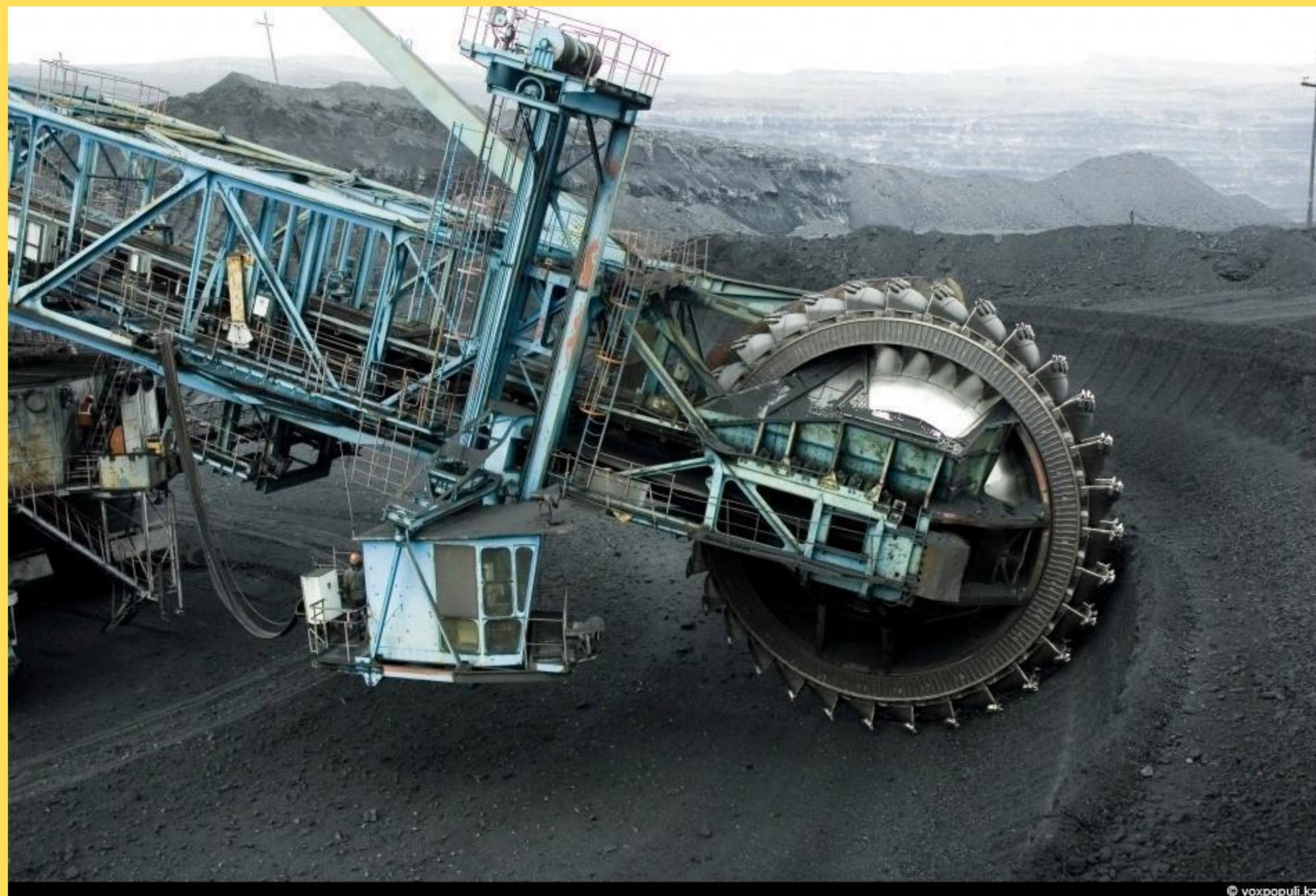
Рабочее оборудование роторных стреловых экскаваторов включает ротор, дисковый питатель и систему транспортеров: приемный, прижимной и отвальный.
