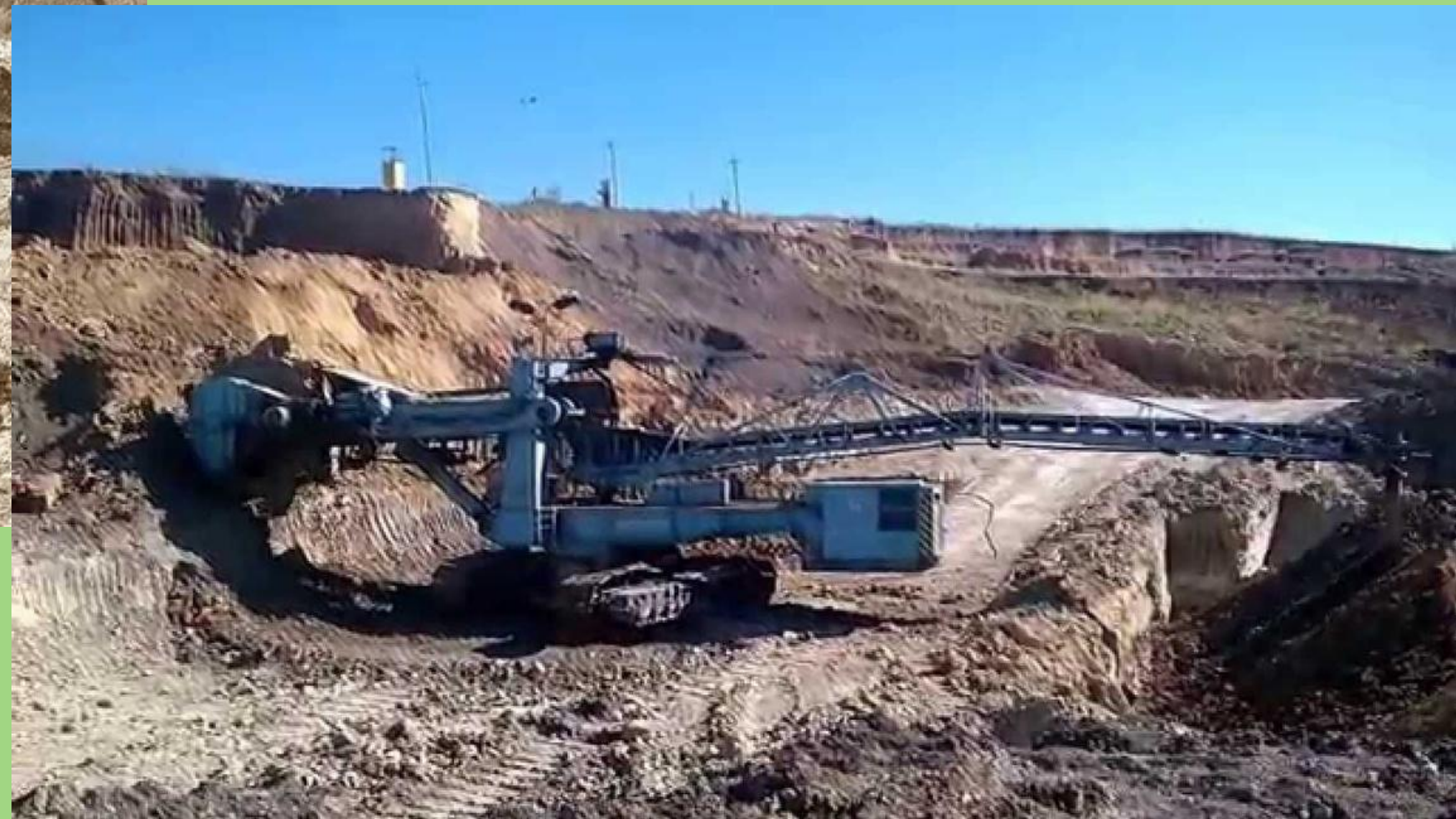
Экскаватор ЭР-1001, выполнен на базе одноковшового экскаватора Э-1602 с дизель-электрическим приводом.
