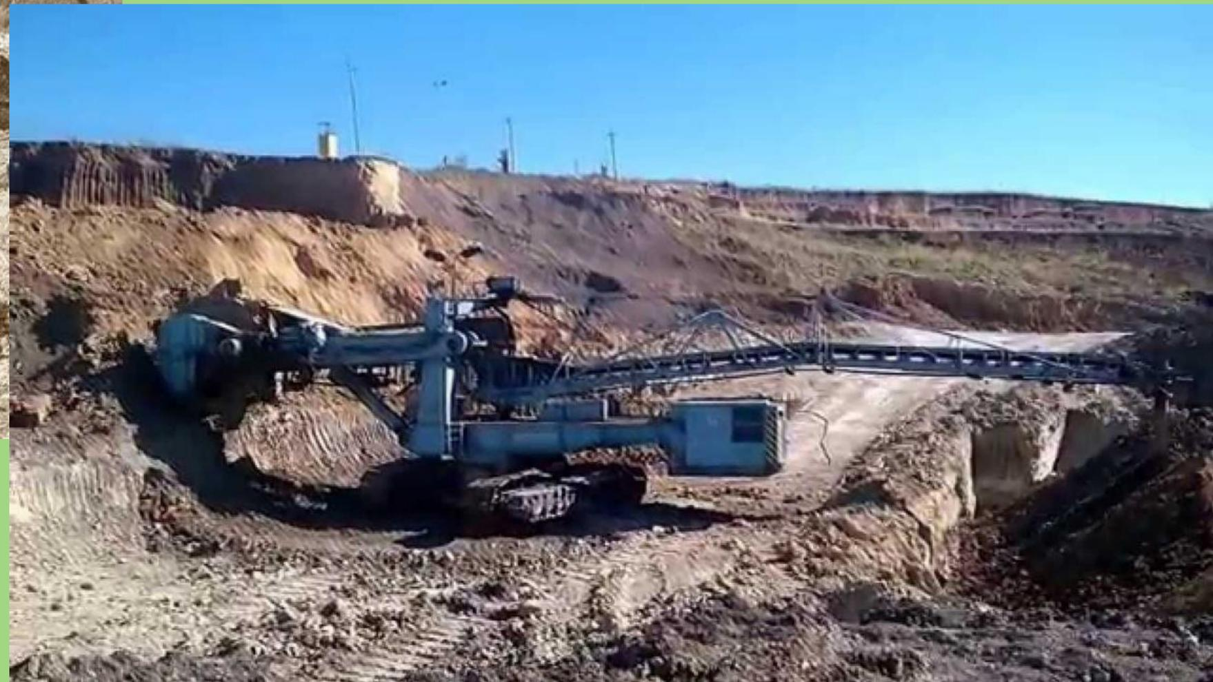
Экскаватор ЭР-1001, выполнен на базе одноковшового экскаватора Э-1602 с дизель-электрическим приводом.
