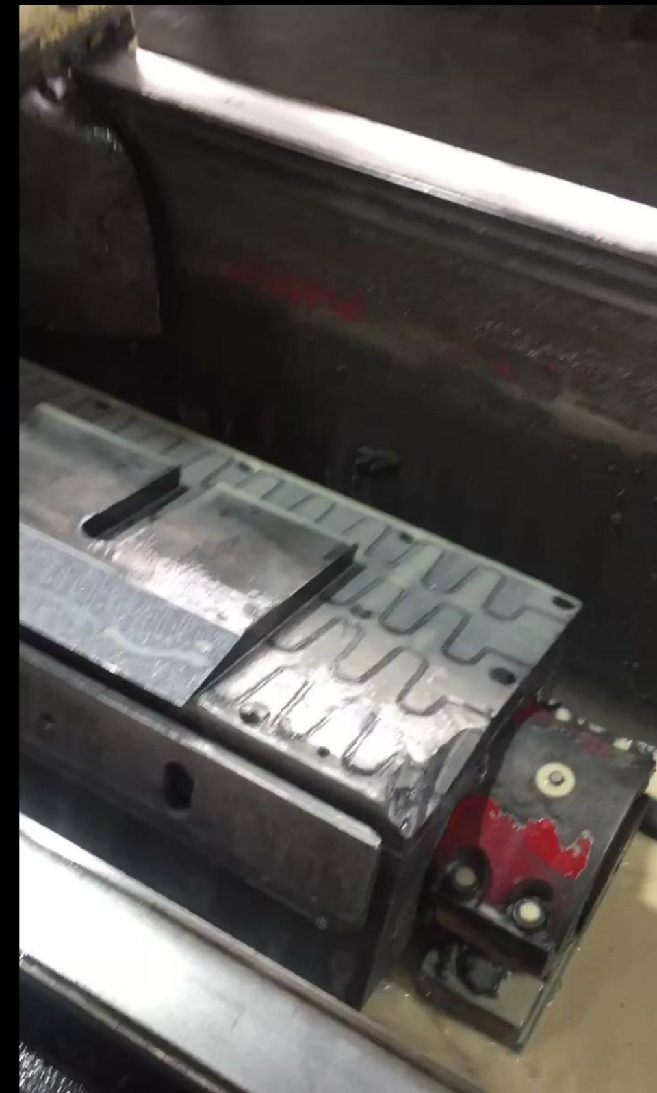
**2.ОТСУТСТВУЕТ РУЧНАЯ ДОВОДКА НОЖА (НАБИВКА МИКРОФАСКИ): ГРУБОЕ ЛУЩЕНИЕ, ПОСЛЕ УСТАНОВКИ НОВОГО НОЖА ВОЗМОЖНЫ ВМЯТИНЫ, СКОЛЫ В НАЧАЛЕ ЛУЩЕНИЯ. ТОЛЬКО СНЯТИЕМ ЗАУСЕНИЦЫ НЕ ПОЛУЧИТСЯ ИСКЛЮЧИТЬ ГРУБОЕ ЛУЩЕНИЕ.**
